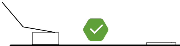
Рисунок 3. Корректное сгибание рычага тампера
