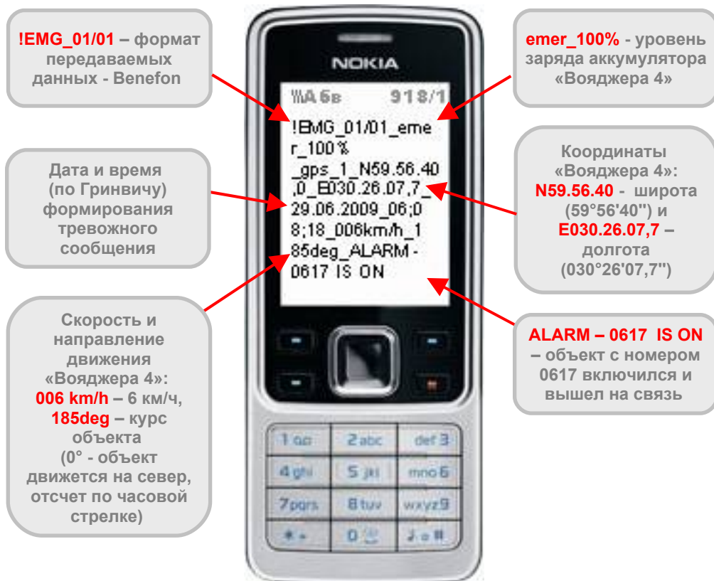
Рис.6.5. Пример SMS-сообщения, которое получает собственник при включении и выходе на связь «Вояджера 4». Для версий прошивки, начиная с VER.07.503.070
