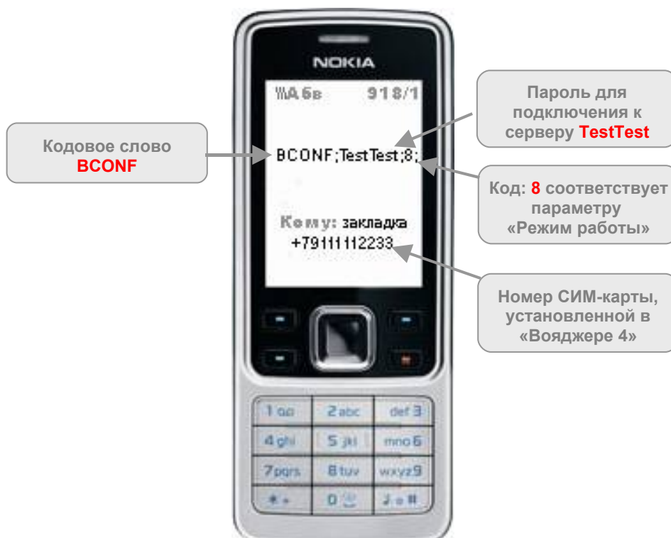
Рис.6.4. Пример запроса на чтение значения из памяти «Вояджера 4» – режима работы – с помощью SMS-сообщения.
