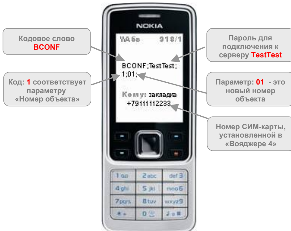
Рис.6.2. Пример настройки нового значения «Вояджера 4» – номера объекта – с помощью SMS-сообщения.
