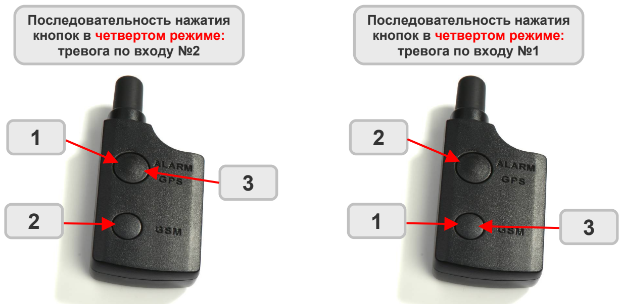
Рис.5.8. Последовательность нажатия кнопок для передачи тревожного сообщения на корпусе «Вояджера 3» в четвертом режиме.
