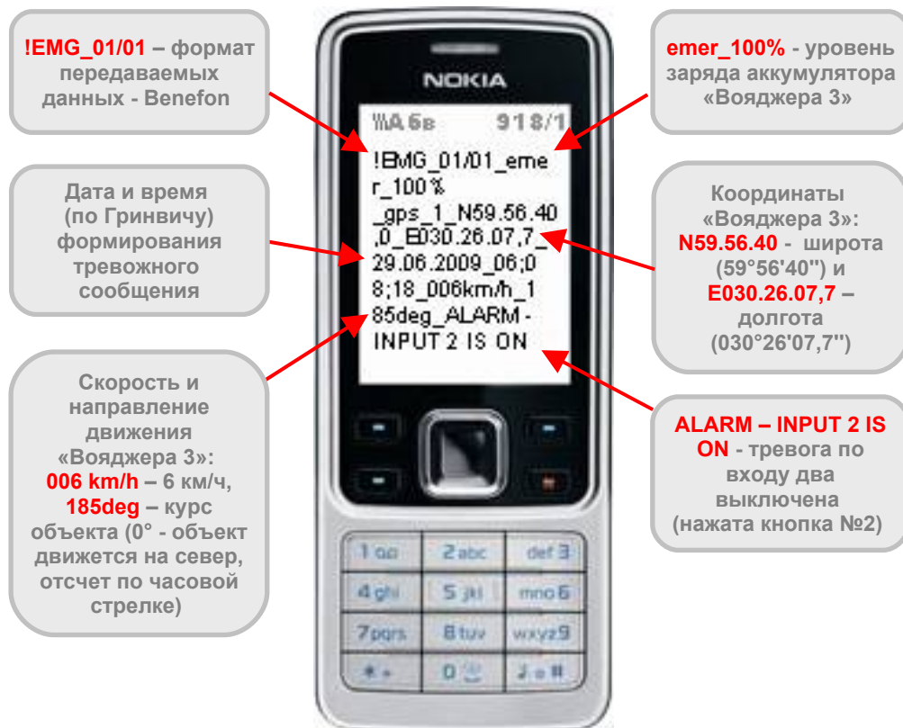
Рис.7. Пример тревожного SMS-сообщения, которое получает собственник при нажатии кнопки на корпусе «Вояджера 3».
