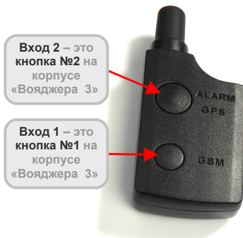
Рис.6. Расположение входов (кнопок) на корпусе «Вояджера 3».
