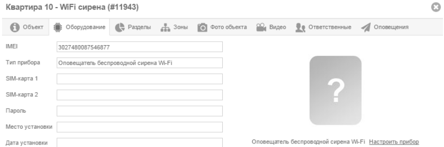
Рисунок 8. Настройка сирены через GEO.RITM
