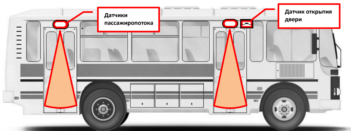
Рис.6.6.2.2. Пример установки датчиков в ПАЗ-4234
