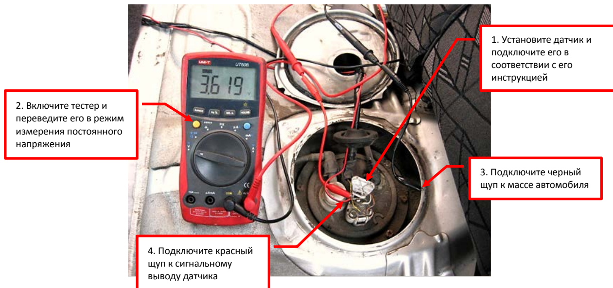
Рис.7.4.1.1. Пример подключения тестера к датчику топлива
