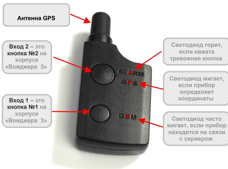
Рис.4.2. Расположение входов (кнопок) на корпусе «Вояджера 3».
