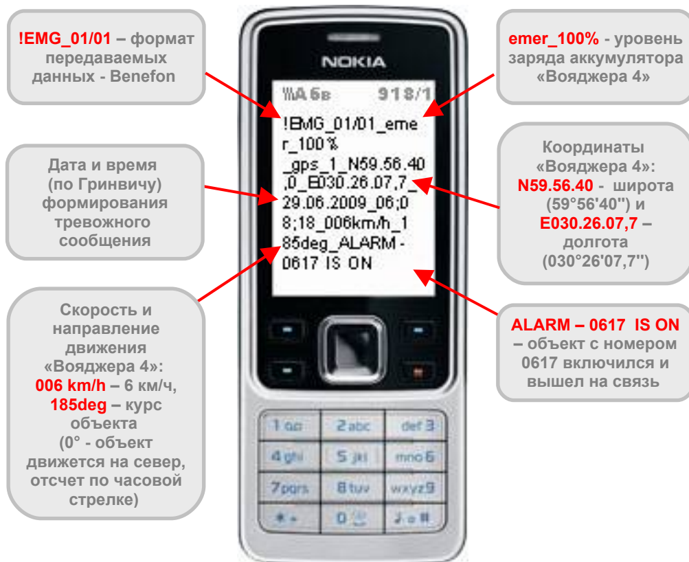
Рис.5.11. Пример SMS-сообщения, которое получает собственник при включении и выходе на связь «Вояджера 4». Для версий прошивки, начиная с VER.07.503.070
